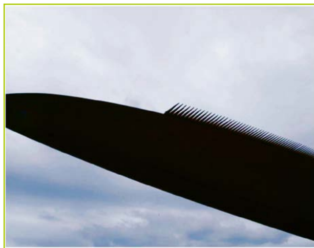
Figure 7 : Exemple de peignes installés sur les bords de fuite des pales d'une éolienne (Source : Evaluation des incidences sur l'environnement de deux projets de plans, Rapport sur les Incidences Environnementales – RIE, Modyva, Sertius et Pissart)
